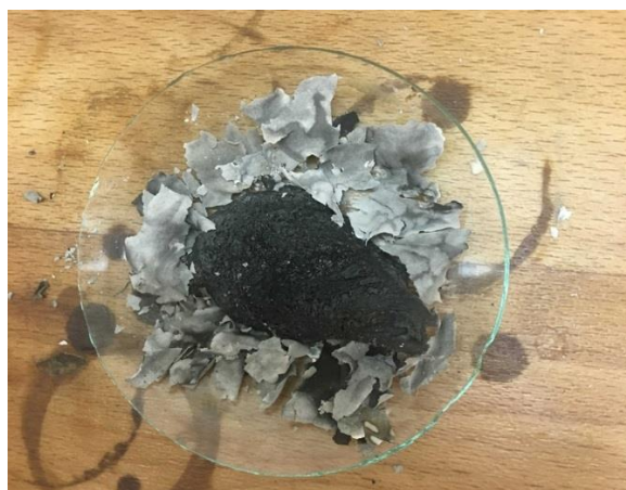
Рис. Фотография поверхности бумаги со сложным эфиром ортофосфорной кислоты на основе 1,4-бутандиола после обработки огнем.
