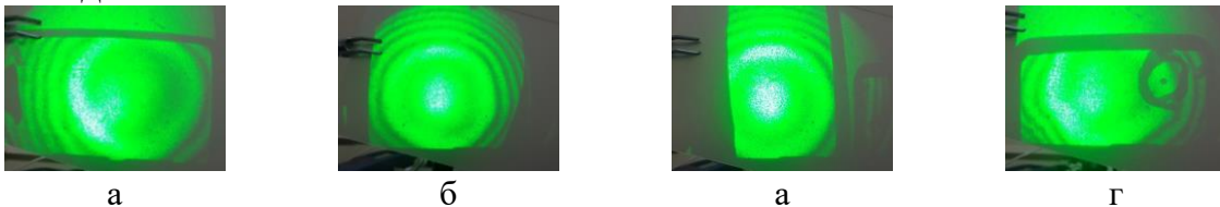
Рис. 1. Коноскопические изображения, полученные на образцах в направлении (001): а – ХЧ, б – ОСЧ, в – производитель из Ужгорода, г – производитель из Китая.
